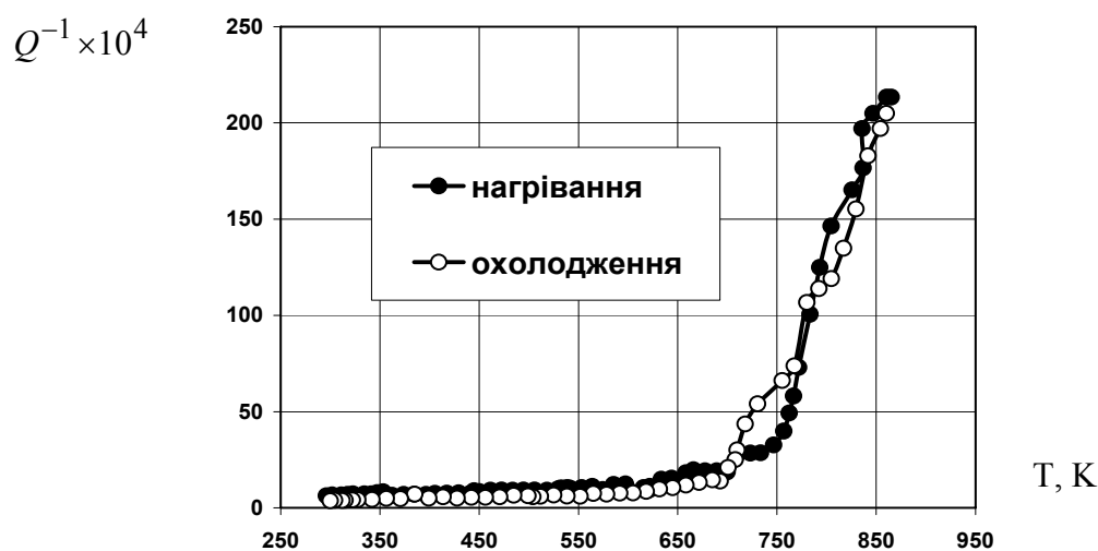
Рис. 1. Температурна залежність внутрішнього тертя сталі 07X12H2МБФ після алмазного вигладжування зусиллям 50 Н
